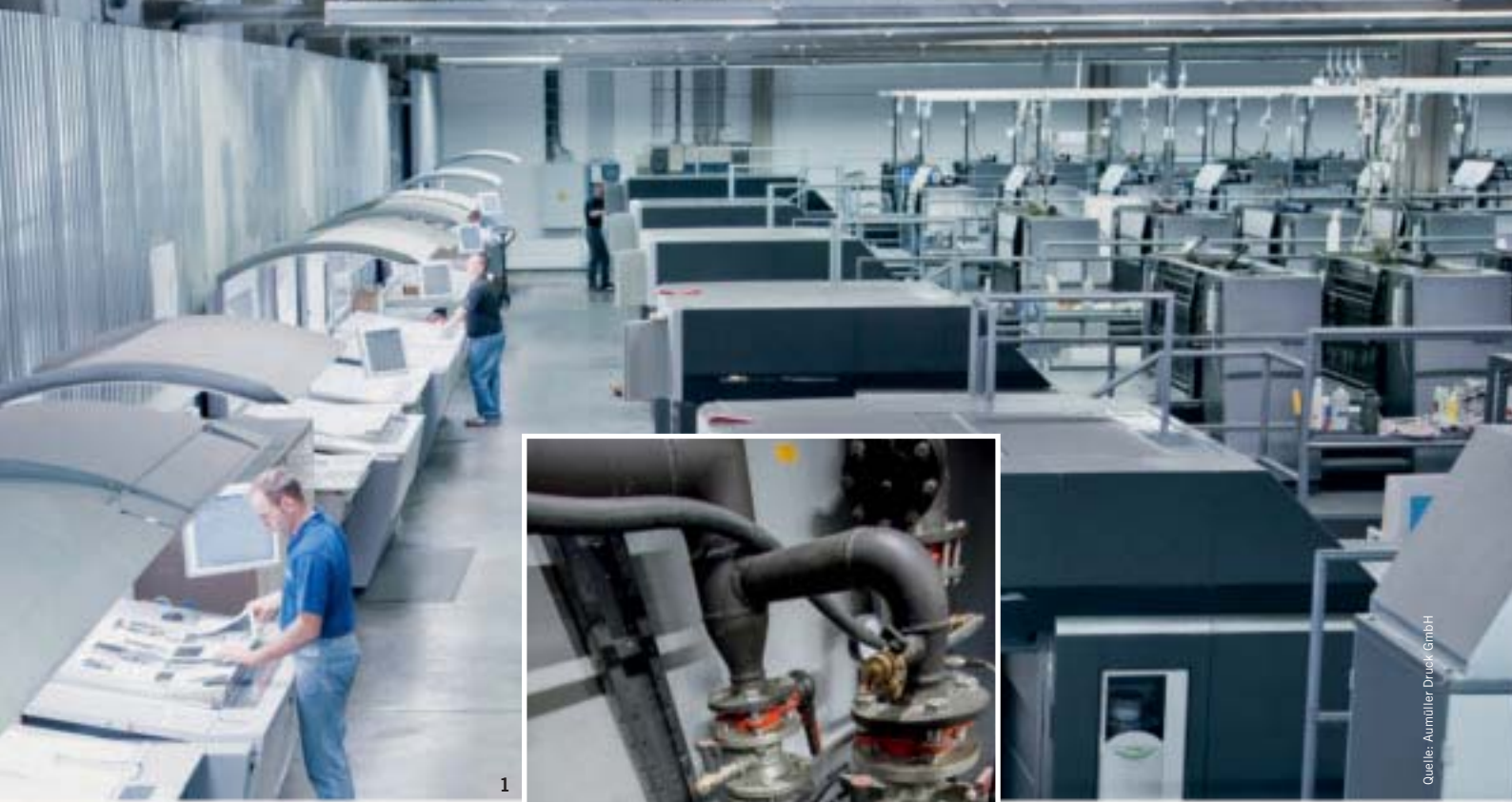
1 Neue hocheffiziente Pumpen sorgen für eine optimale Kühlung der Druckanlagen bei Aumüller. 2 Grundlage des Pumpen-Energiespar-Concepts bildet die moderne Technologie von Grundfos.
